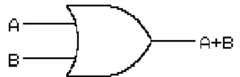
Fig. 3.10. Simbolul logic al functiei SAU.
