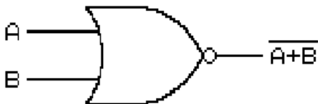
Fig. 3.11. Simbolul logic al functiei SAU NU (NOR).
