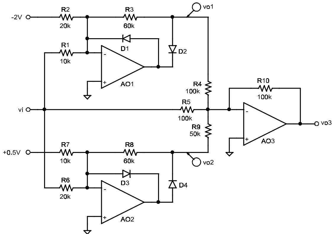
Considerând AO din circuit ideale să se traseze caracteristicile de transfer la ieșirile:
