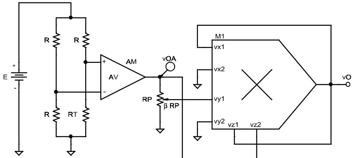
În figură este reprezentat un circuit de măsurare pentru un traductor rezistiv,  $RT = R \times (1 + \delta)$ , cu liniarizarea caracteristicii cu ajutorul unui multiplicator având caracteristica:
