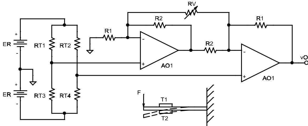
În puntea rezistivă,  $RT_1$ ,  $RT_2$ ,  $RT_3$  și  $RT_4$ , două dintre rezistențe sunt traductoare tensometrice  $T_1$  și  $T_2$  montate pe fețele opuse ale unei grinzi care se deformează sub acțiunea forței  $F$ . Amplificatoarele operaționale  $AO_1$  și  $AO_2$  sunt considerate ideale. Se cere:
