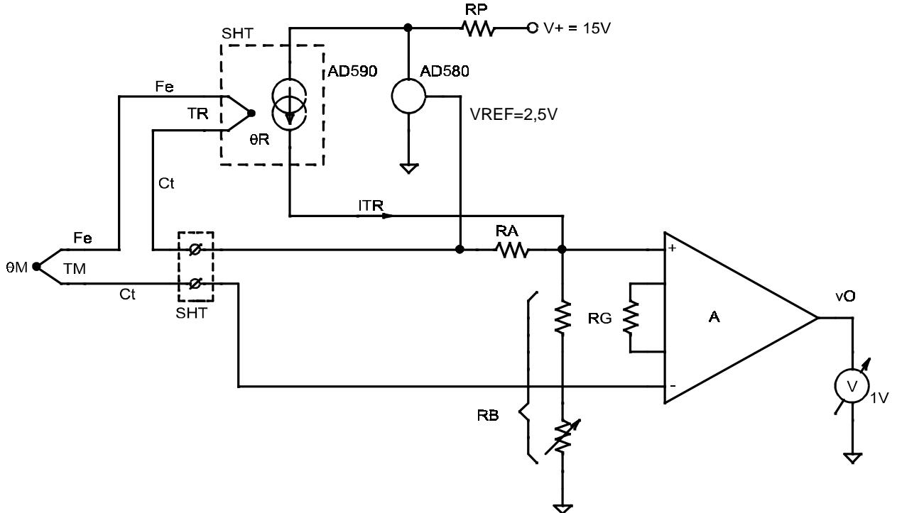
În figură este reprezentat un circuit pentru măsurarea temperaturii cu termocouple fier–constantan fără termostatarea sudurii reci,  $\theta_R$ , care poate urmări variațiile temperaturii ambiante,  $\theta_R = \theta_A$ . Variațiile temperaturii ambiante sunt măsurate cu traductorul integrat AD590 care, polarizat cu o tensiune minimă de 2 V generează un curent
