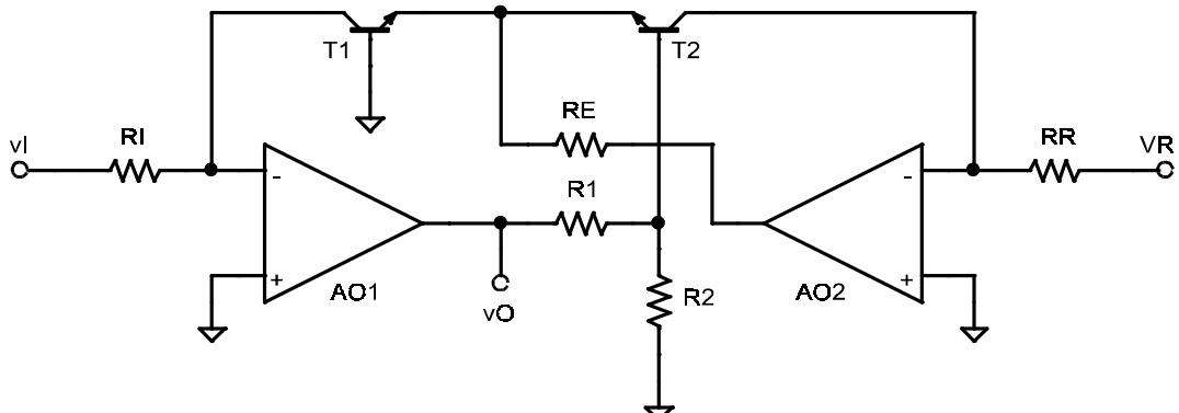
În convertorul logaritmic din figură tranzistoarele T1 și T2 sunt termostatate la temperatura pentru care  $V_T = 25 \text{ mV}$ , au  $\beta_F \geq 200$  și, în limitele unei erori admisibile (1 %)  $i_C = I_S \cdot e^{\frac{v_{BE}}{V_T}}$  pentru  $i_C \in [\sqrt{10} \text{ nA}, \sqrt{10} \text{ mA}]$ . Dacă AO sunt ideale și  $VR = 2,5 \text{ V}$  se cere:
